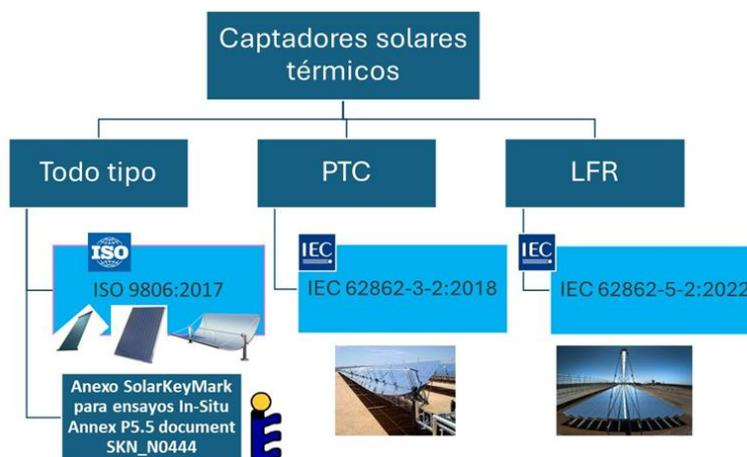
Figura 35. Normas para ensayos de captadores solares.
