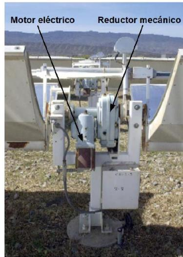
a) motor eléctrico con reductora
