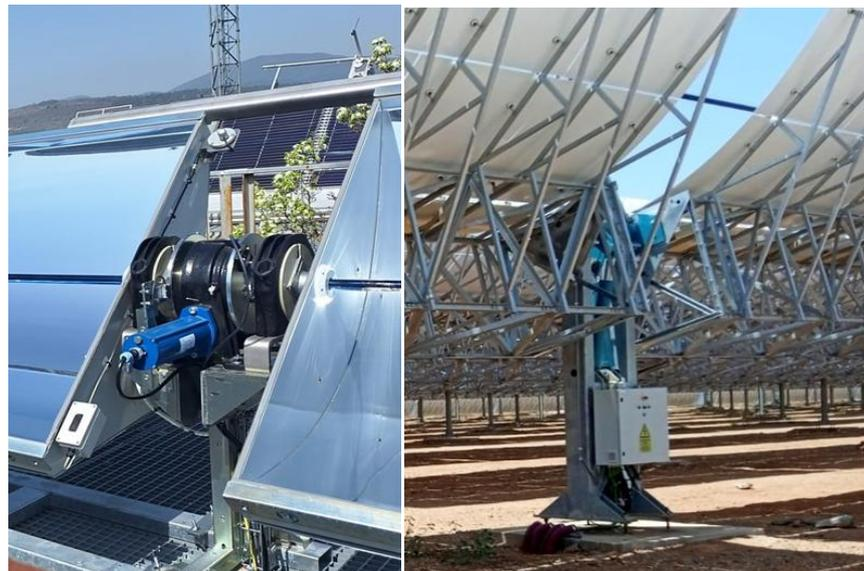
Figura 47. Diferentes tipos de mecanismos de accionamiento eléctrico - hidráulico (Zarza, 2023).
